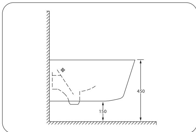
**5)** Conecte el fluxómetro a la tubería de agua en la pared y a la entrada del inodoro con la tubería adecuada. Asegure todas las uniones con cinta de teflón para evitar fugas. Asegure las medidas correctas.
