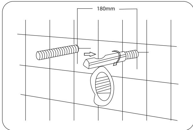
**3)** Ubique la tubería de desagüe en la pared. Monta el inodoro en los pernos del soporte.
