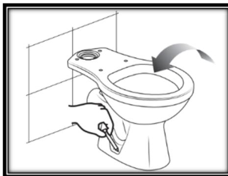
5. Se debe medir el grosor de la loza, para que en las marcas realizadas de las fijaciones se puedan tomar las medidas para colocar las escuadras internar sumándole 10-15mm. Posteriormente, realizar las perforaciones en loza e instalar los tarugos.
