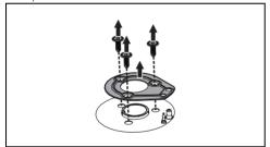
Quite las juntas de las bujías y los termopares de cada quemador.
