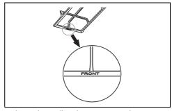
Coloque las rejillas de manera que las marcas «FRONT» queden orientadas hacia los mandos de la encimera.
