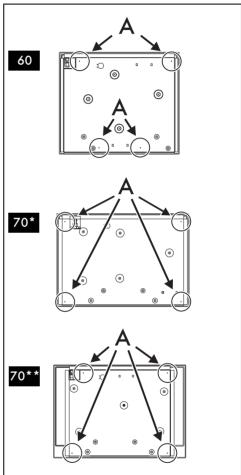
Atornille las abrazaderas de fijación en los orificios indicados para fijar correctamente la encimera de cocción a la estructura
