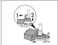
Utilice una llave de 7 mm para quitar el inyector y sustituirlo por otro que se adecue al nuevo tipo de gas conforme a las indicaciones de la tablas correspondientes
