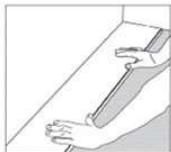
• Primero determine la dirección para instalar las tablas. Como regla general, los tablonos normalmente se instalan funcionando en la dirección larga de la sala principal. Colocar una marca en el centro del piso en cada extremo de la habitación. Trace una línea de tiza entre las marcas.
