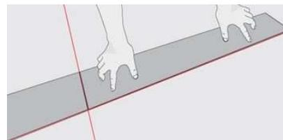
• Aplique el adhesivo con la llana dentada recomendada, extienda el adhesivo sobre la mitad del piso hasta la línea central.
