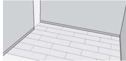
El orden de pegado y los cortes de la primera y segunda hilera se van repitiendo en las otras filas, hasta completar todo el espacio.
