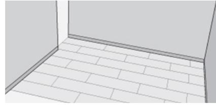
El orden de pegado y los cortes de la primera y segunda hilera se van repitiendo en las otras filas, hasta completar todo el espacio.
