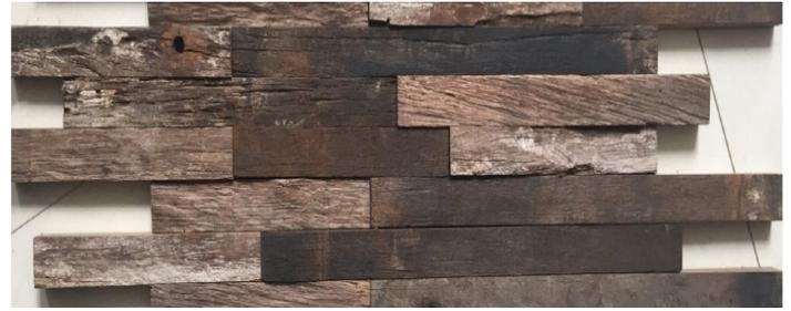
La instalación puede ser en muro de hormigón, carpetas a base de sulfato de calcio(yeso),tableros OSB, piedra, cerámica y azulejos. Se debe considerar dilatación perimetral de 5mm, en el caso de instalación es confinadas entre dos muros.
