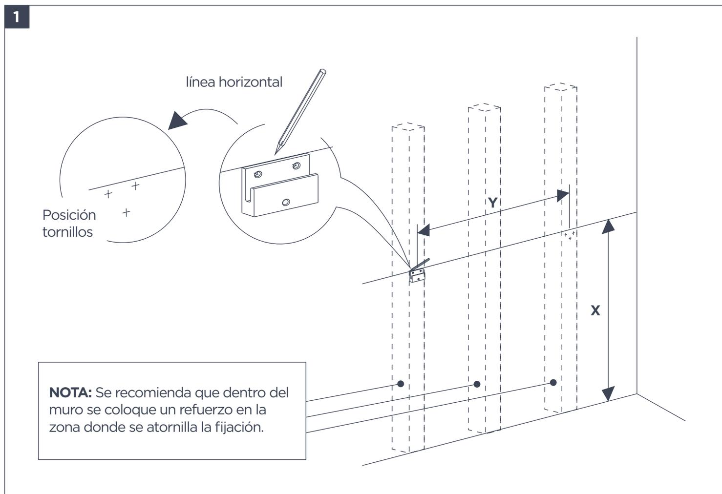
X: Equivale a la distancia entre el piso y la parte superior del mueble a instalar.
