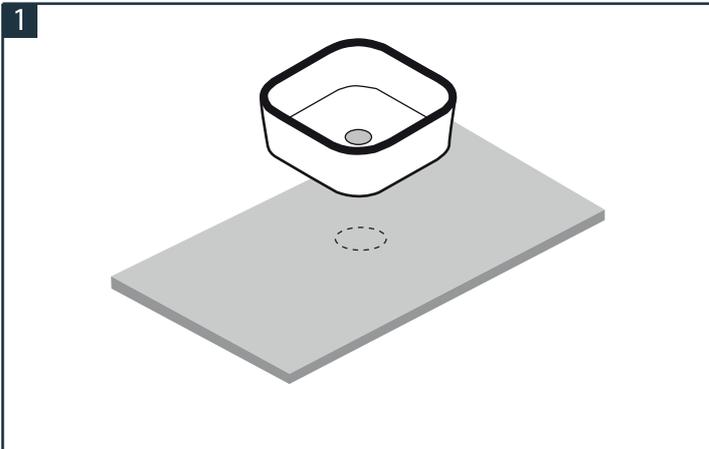
Confirmar que la marca en el tocador se alinea con el lavamanos y que está centrado. Luego cortar el agujero del tamaño de la tubería.
