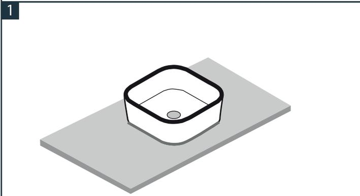
Después de aplicar el adhesivo de silicona, instale cuidadosamente lavabo sobre la encimera y presione firmemente hacia abajo y recorte cualquier exceso de sellador.
