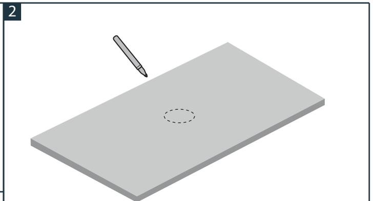
Marcar el diametro exterior del desagüe y cortar. Medir con precisión el centro el centro y trazarlo en la cubierta. Antes de cortar el mostrador, asegúrese de que esté centrado en la cubierta y el lavamanos.
