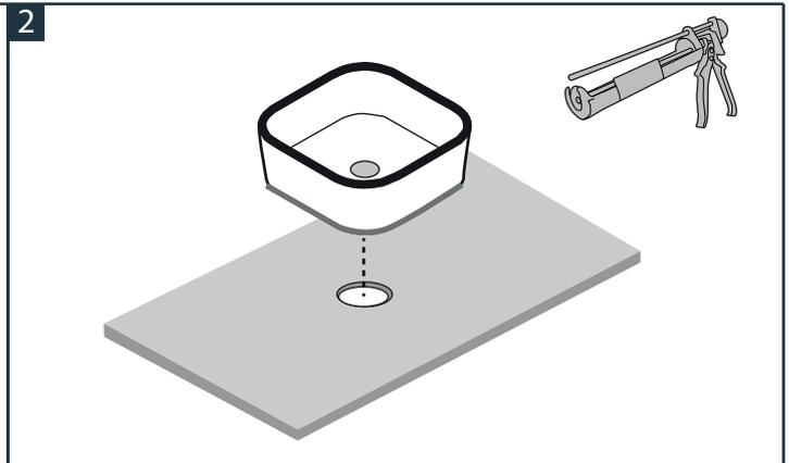
Verificar que esté centrado y nivelado instalando el lavamanos encima de la cubierta. Posteriormente pegar el lavamanos a la cubierta con silicona.
