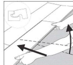
• **Empuje con cuidado la tabla hacia abajo hasta que el click se una** en lado corto de la tabla, presione hacia abajo firmemente en la unión del extremo, preferiblemente golpeando con un mazo de goma para enganchar completamente el extremo corto.
