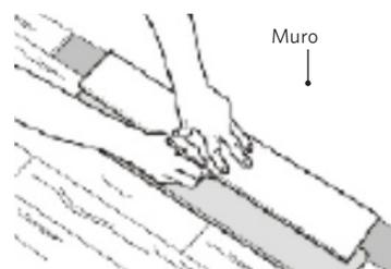
• **Marque donde se cortará la tabla**. Si el ajuste de la pared es simple y recto, mida para el ajuste y corte correctos.
