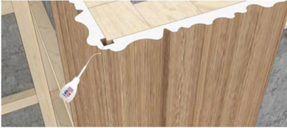
**4.** Instale el panel de pared en cada viga de madera con clavos de aire en un ángulo de 45°. Como se muestra a continuación.
