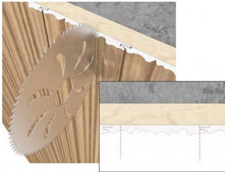
**2.** Retire la parte central del panel de la pared y las partes restantes que deben reemplazarse después del corte.
