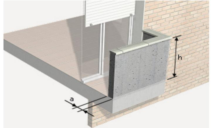
En fachadas proteger las aristas superiores del mosaico de piedra o cerámico con cornisas, vierte aguas similares, para evitar la penetración de agua entre el soporte y la pieza durante y después de la colocación. Recomendamos utilizar el adhesivo de LATICRETE PLATINUM 254 o BEKRON STEEL.
