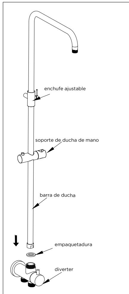
**3)** Conectar el divisor y la barra de ducha. Apriete. Recuerde colocar la empaquetadura entre estas dos partes.
