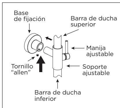
**5)** Inserte el soporte ajustable en la base de fijación. Ajuste la distancia con relación al muro y verifique que la barra de ducha esté en posición vertical. Apriete con una llave para asegurar el empalme.
