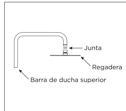
**9)** Conecte la regadera a la barra de ducha superior y apriétela para garantizar un buen ajuste.
