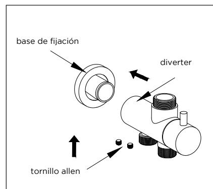
**2)** Inserte el desviador en la base de fijación. Luego apriete con un tornillo allen.
