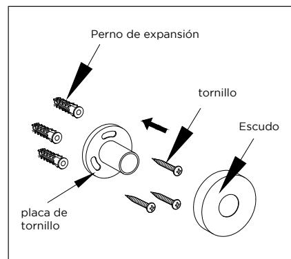
**1)** Marque la posición y taladre 3 agujeros. Golpee los pernos de expansión y fije la placa de tornillos a la pared con pernos. Luego atornille la base de fijación.
