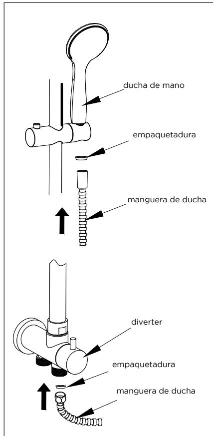
**7)** Conecte la manguera de la ducha al divisor y a la ducha manual. Apriétela para garantizar un buen ajuste.
