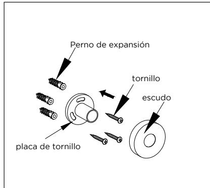
**4)** Marque la posición del soporte ajustable y perfore 3 orificios en los puntos marcados.
