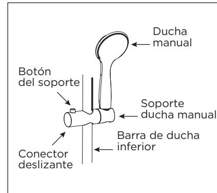
**8)** El conector deslizante se puede desplazar cuando se presiona el botón del soporte.
