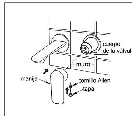
5- Ajuste la manija con un tornillo Allen y luego cubra el orificio del tornillo con la tapa.
