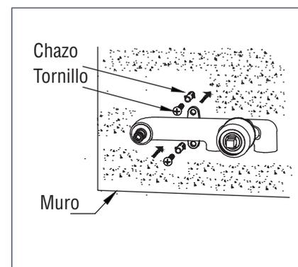
1- Ajuste el cuerpo de la válvula en el muro usando 2 tornillos.
