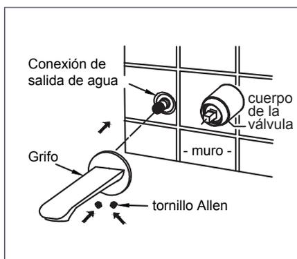
3- Remueva la cubierta de la salida de agua. Ajuste el grifo en la conexión de la salida de agua con 2 tornillos Allen. Asegúrese de que la base redonda del grifo quede muy bien adherida al muro.
