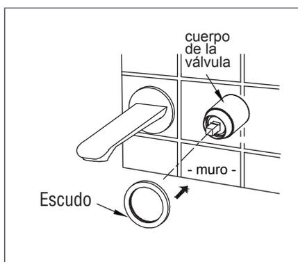
4- Revise si hay un O-ring en el fondo del Escudo. Retire el cartucho protector y coloque el escudo en el cuerpo de la válvula. Asegúrese de que el escudo quede muy bien adherido al muro.
