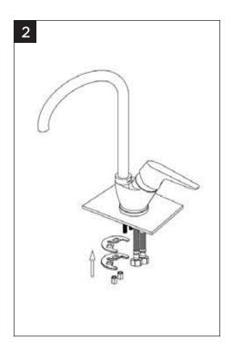
**2-** Deslice la arandela negra en forma de "C" y luego la platina retenedora de metal hacia arriba del faldón y ajústelas apretando la tuerca de fijación.
