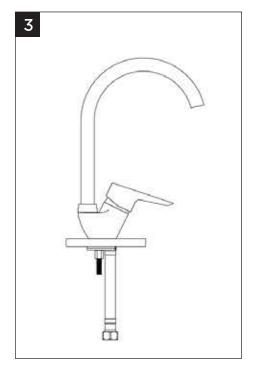
**3-** Revise que el cuerpo de la grifería esté correctamente ubicado y ajuste la tuerca. La grifería debe estar fijada con firmeza pero no debe excederse en su fijación ya que puede causar daños al lavamanos.
