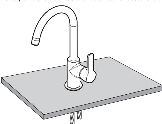
**4** Insertar la arandela de goma y la arandela de hierro en el espárrago, luego atornillar la tuerca en el espárrago para fijar el cuerpo mezclador.
