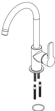
**3** Instalar el cuerpo mezclador con la base en el tablero de la mesa.
