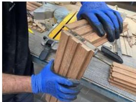
**3.** Una vez identificado el extremo con el que se hará la tapa, se debe hacer un corte de 45° en la parte posterior de la pieza.
