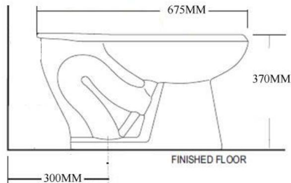
**Importante:** Las dimensiones son nominales y en milímetros, Estas pueden variar +- 3 % según los rangos de tolerancia establecidos por la norma de fabricación ASME A111
