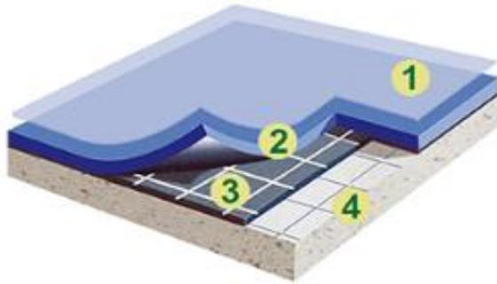
1. RECUBRIMIENTO DE POLIURETANO (PUR) DE FÁCIL MANTENIMIENTO
