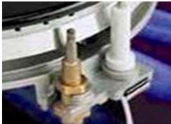
**Sistema de seguridad TERMOPAR**, este sistema permite cortar el paso del gas en caso de apagado accidental de la llama. Una pequeña válvula detecta la ausencia de llama y corta el paso del gas, para evitar algún accidente.
