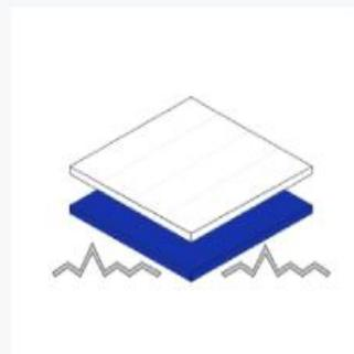
Compensa las irregularidades<sup>5</sup> de la losa o radier, evitando que el piso laminado se estropee, sobretodo en las zonas de alto tráfico.
