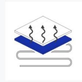
Nuestras bases son aptas para el uso de losa radiante<sup>7</sup>, ya que proporcionan el aislamiento térmico necesario para que la calefacción resulte eficaz.
