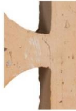
Pequeñas ralladuras que no comprometen la integridad de las piezas.
