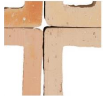
Bordes irregulares entre las piezas
