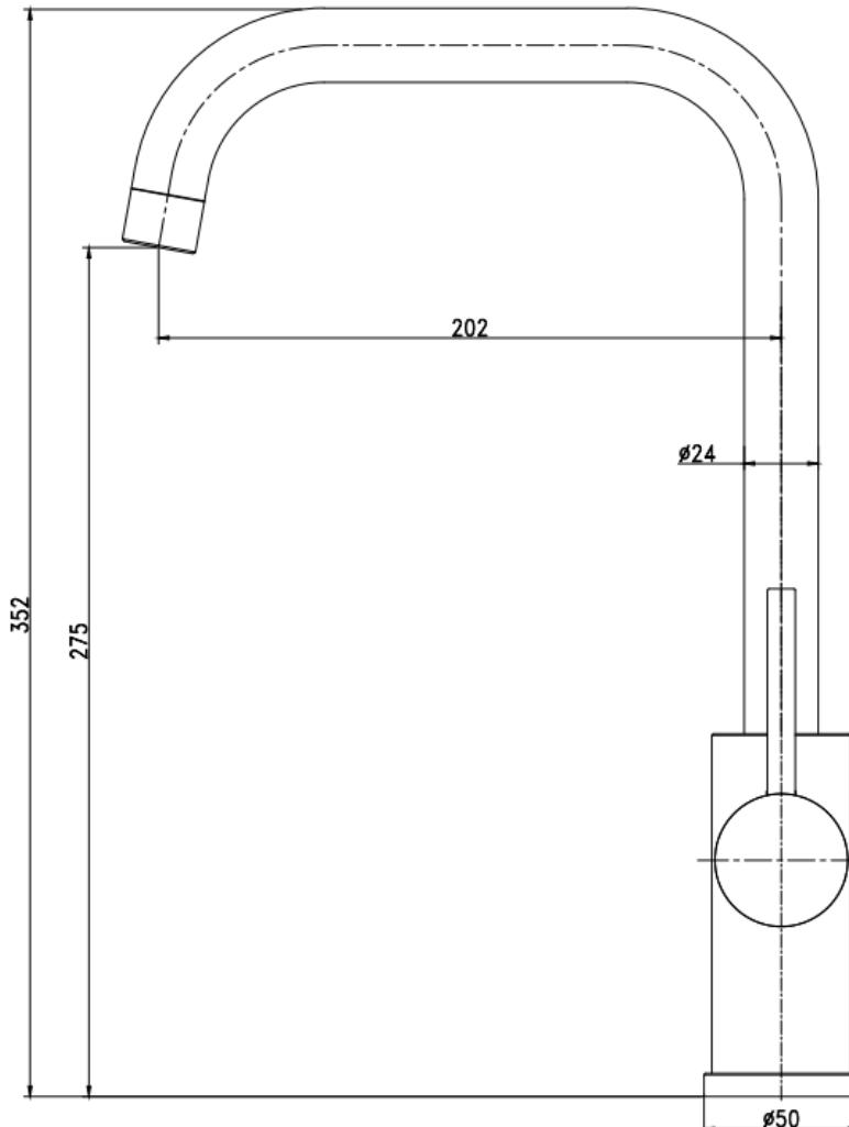
**Observación:** La maneta / manilla se instala al costado derecho de la grifería por lo que el indicador de agua caliente queda mirando hacia el muro.
